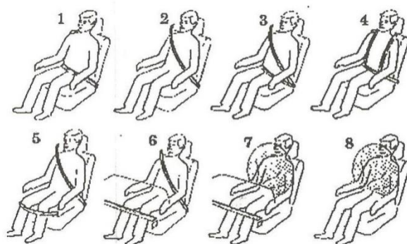
Слика 48. Врсте сигурносних појасева, где су: 1) трбушни, 2) дијагонални, 3) појас у три тачке, 4) појас у четири тачке, 5) дијагонални + појас за колена 6) дијагонални + заштитник за колена, 7) заштитник за колена + ваздушни јастук, 8) ваздушни јастук
