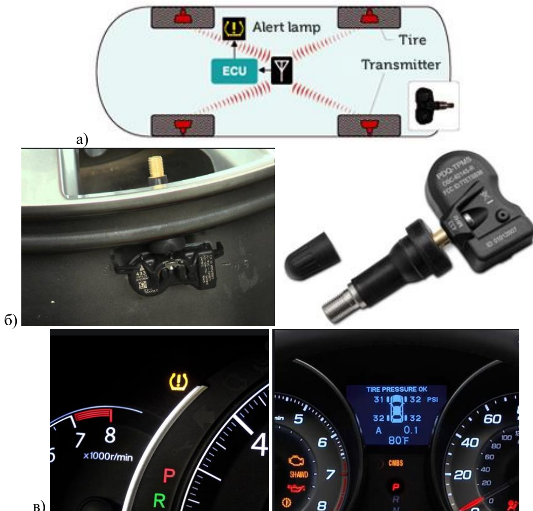
Слика 34. TMS- Tyre Pressure Monitoring System
