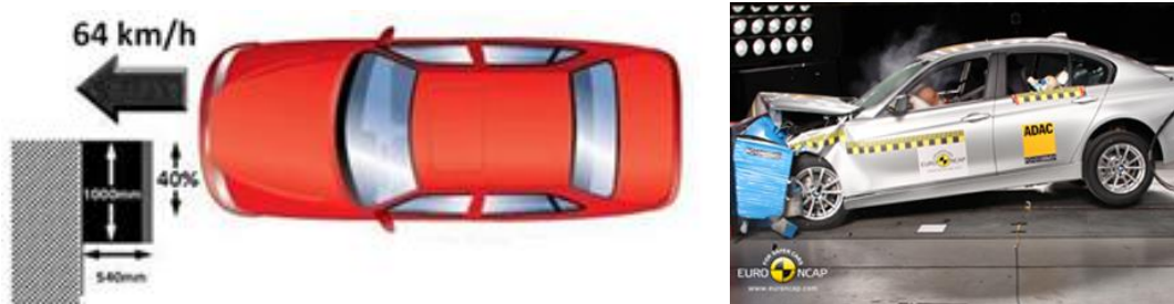
Слика 80. Приказ процеса испитивања чеоног дела возила као и пример једног теста
