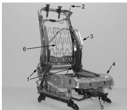
Слика 62. Структура предњег седишта код возила са троје врата
