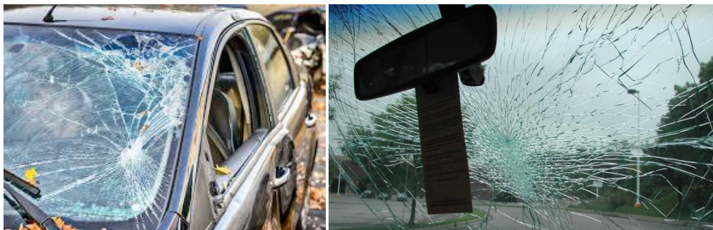
Слика 87. Приказ слојевитог стакла после саобраћајне незгоде
