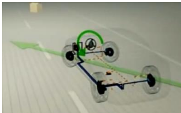
Слика 26. Промена угла положаја точка управљача и слање информација сензора управљача ка управљачкој јединици
