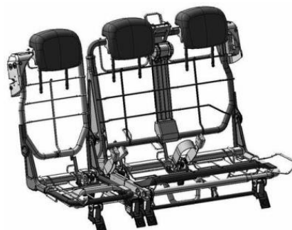
Слика 64. Приказ изгледа конструкције задњих седишта
