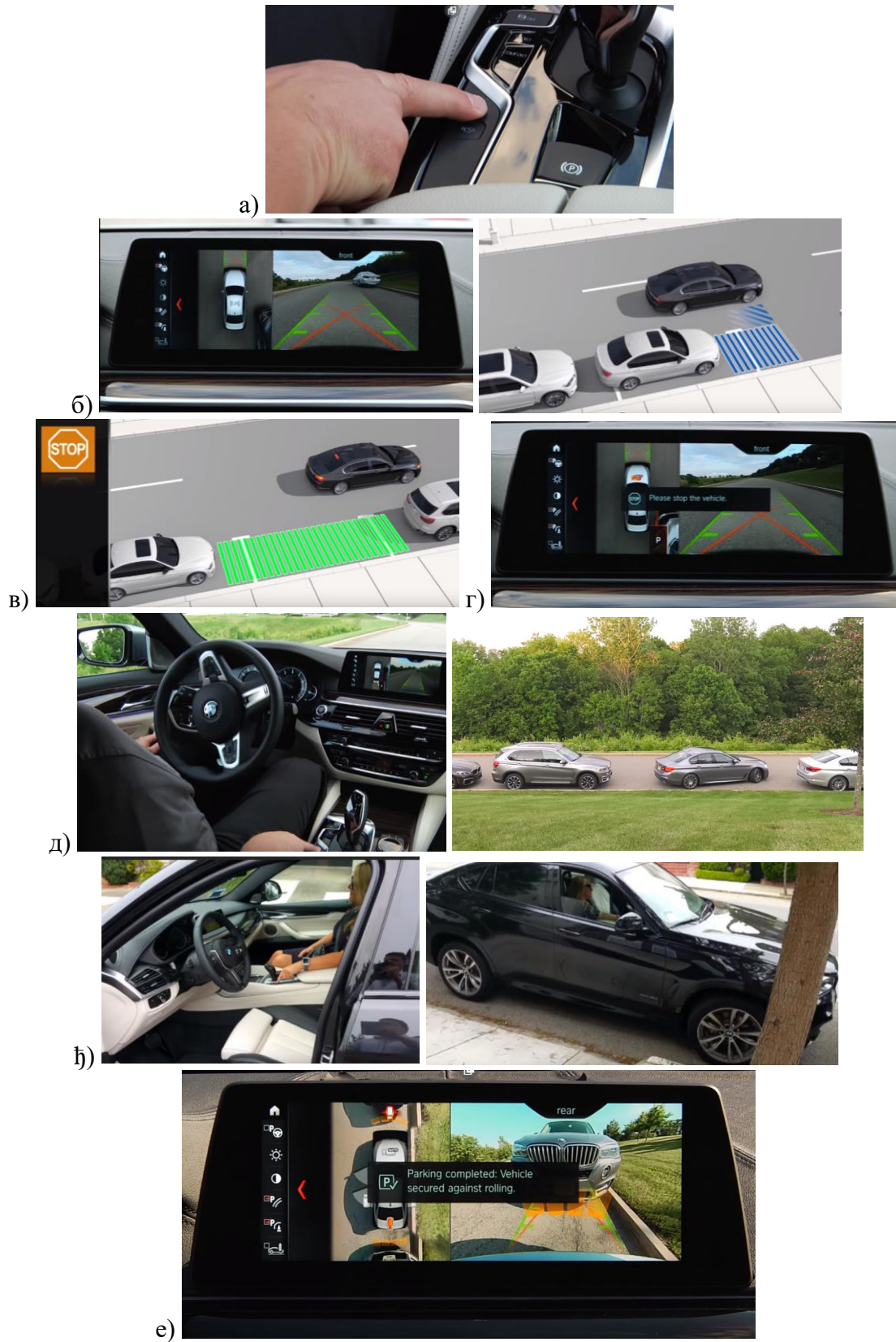
Слика 42. Самопаркирање возила са системом „Park assist“ на примеру реалног возила
