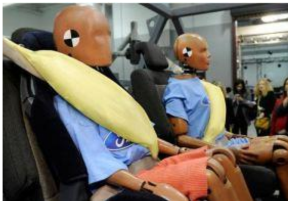
Слика 55. Пример сигурносних појасева са ваздушним пуњењем
