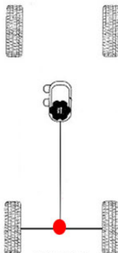
Слика 17. Шема једноканалног ABS система
