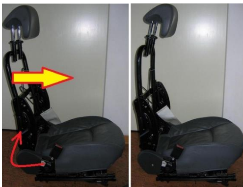
Слика 68. Приказ рада система активног седишта као и положај пре и после незгоде
