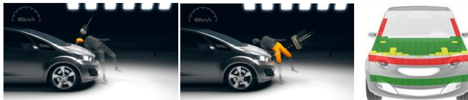
Слика 83. Приказ испитивања удара возила у пешака као и приказ критичних зона удара пешака (зоне које су критичне и изазивају веће повреде код пешака у случају незгоде)
