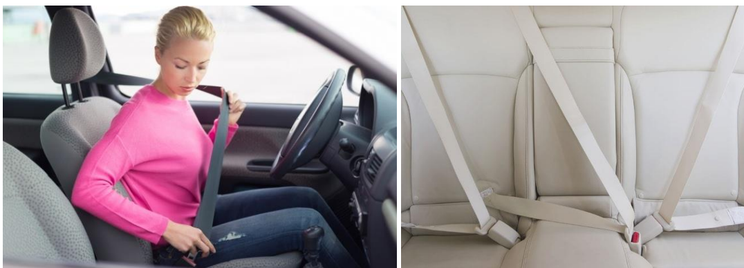
Слика 47. Приказ примера примене сигурносног појаса као и изглед појаса на задњем седишту возила
