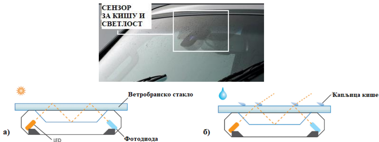
Слика 46. Сензор за кишу и за светлост (позиција и принцип рада давача за кишу), где је: а) случај када нема падавина, б) случај када им падавина
