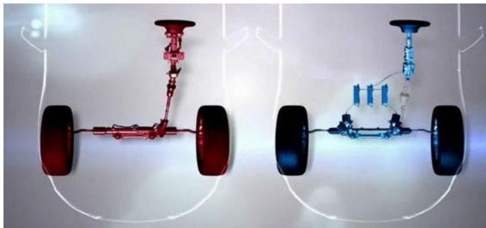
Слика 93. Приказ конвенционалног система управља возилом (лево) и система електронског управљања возилом (десно)
