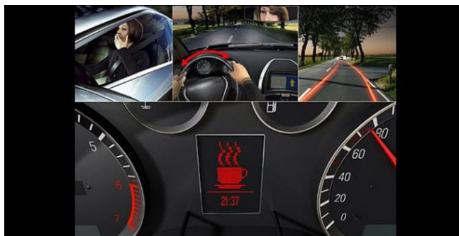
Слика 43. Пример упозорења возача на умор од стране система за детекцију умора
