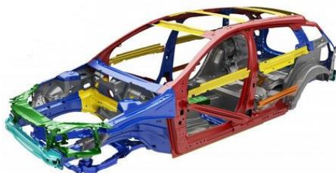
Слика 77. Приказ концепције градње каросерије возила применом различитих материјала
