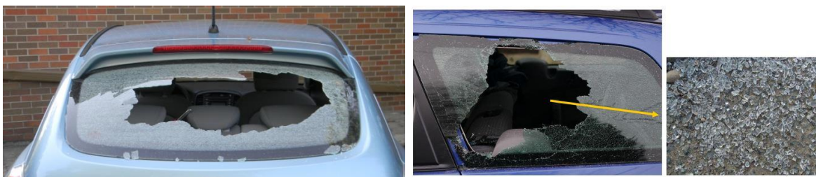
Слика 88. Приказ стакала на задњим и пртљажним вратима након саобраћајне незгоде
