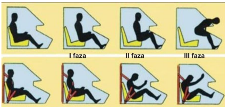
Слика 50. Положај путника без појаса и са појасом у току чеоног удара
